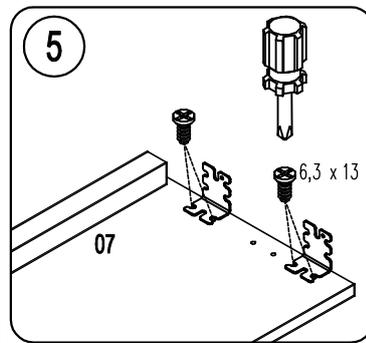
Закрепить уголок на детали 07 тремя шурупами, с помощью молотка утопить шпиль уголка в деталь и подтянуть шурупы.
